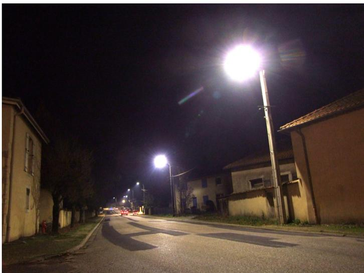
Par souci d'économie, la totalité de l'éclairage public de la commune est désormais assurée par des lampadaires équipés d'ampoules « Led » d'une puissance de 60 watts. L'économie réalisée n'influe en rien sur la qualité finale de l'installation qui reste aussi performante.
